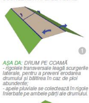
SCHEMĂ EXPLICATIVĂ: AȘEZAREA DRUMULUI ȘI MODUL DE SCURGERE A APEI DE PLOAIE
