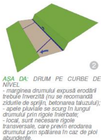
SCHEMĂ EXPLICATIVĂ: AȘEZAREA DRUMULUI ȘI MODUL DE SCURGERE A APEI DE PLOAIE
